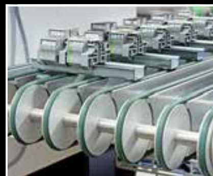
Unidade de classificação e armazenamento intermediário de réguas de bornes prontas
