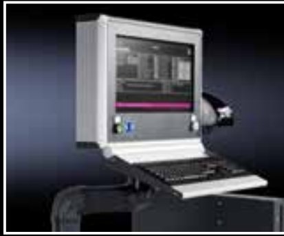
Operação da máquina com teclado e impressão de etiquetas para atribuição dos itens ao respectivo projeto se for utilizada a otimização do corte
