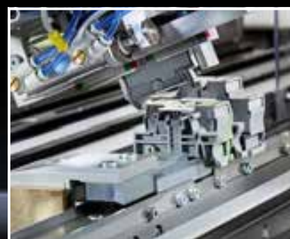
Montagem automatizada de bornes e identificação por meio de sistema de marcação a laser
