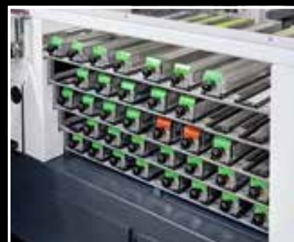
Estoque de até 80 magazines para réguas de bornes, disjuntores, etc.
