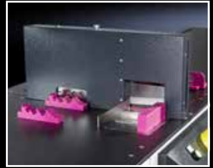
Unidade para cortar trilhos de suporte e canaletas de cabos
